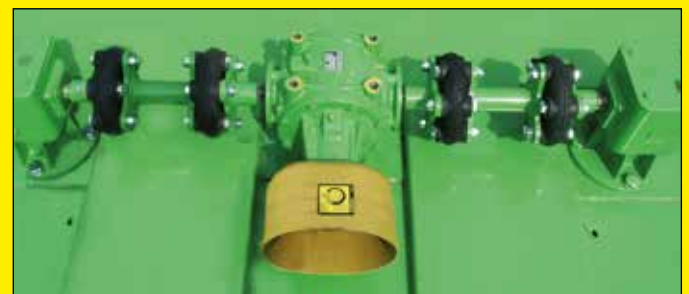
Kraftübertragung mit vierfachem Torsionsschutz
