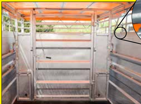
Innere Tür mit einer Klinke zum sicheren Öffnen von Außen ausgestattet
