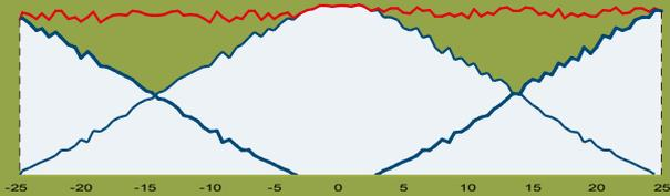
Die asymmetrische Öffnung der Dosierschieber hält den Aufgabepunkt unabhängig von der Streumenge und der Fahrgeschwindigkeit in der richtigen Position.
