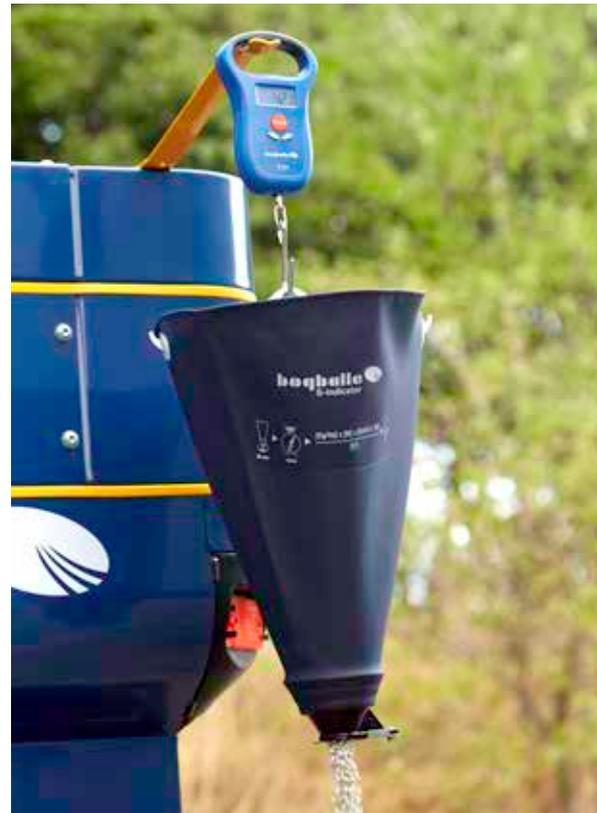
Der S-Indikator ist einfach zu bedienen und eine komplette Abdrehrprobe eines bestimmten Düngers wird in wenigen Minuten durchgeführt.
