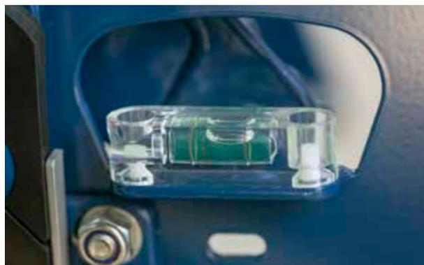
Der L15 befindet sich immer in horizontaler Position. Um eine korrekte Montage zu gewährleisten, ist am Oberlenkerbock eine feste Wasserwaage angebracht.
