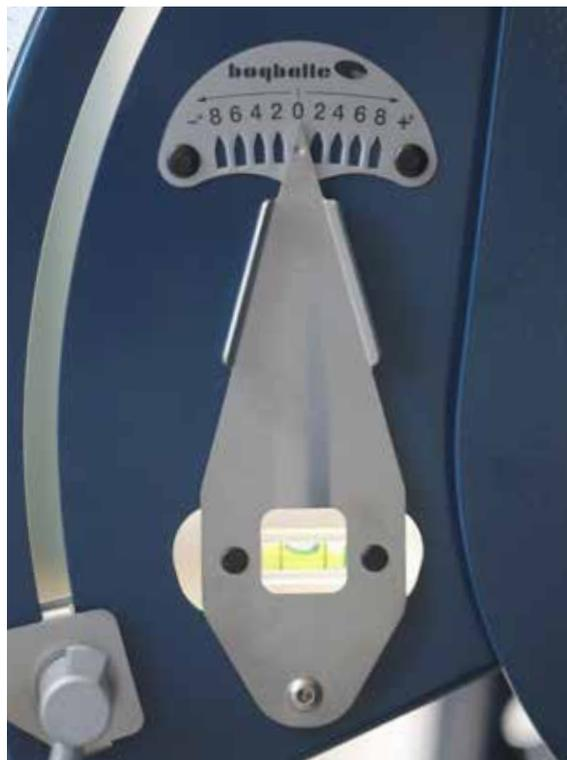
Die Wasserwaage am Oberlenker ist parallel zu den Streuscheiben befestigt und dient als Bezugspunkt für die korrekte Kalibrierung des Arbeitswinkels des Streuers (M-Linie + L20 (W)).
