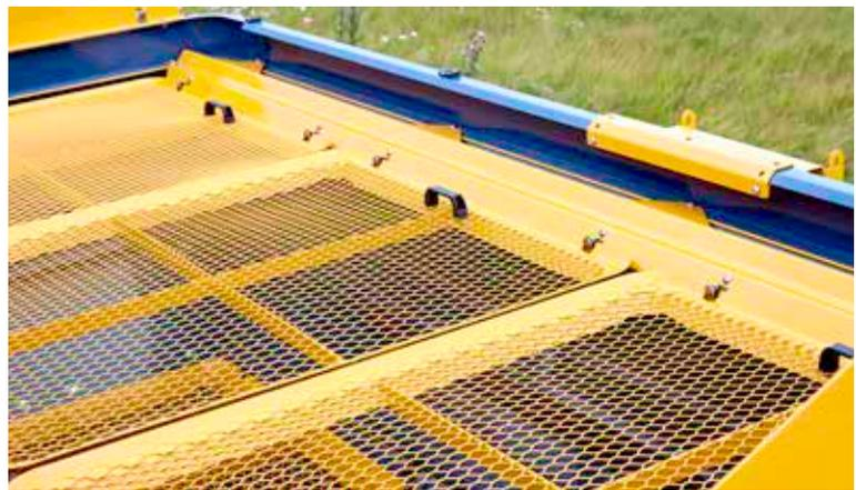
Spezialsiebe, zwischen zwei oberen Modulen
