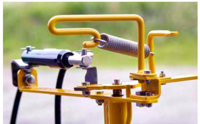
Hydraulische Fernsteuerung der Grenzsteuerung
